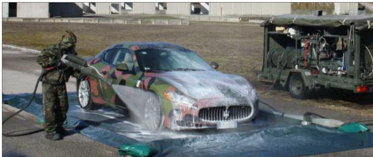
Remolque ligero, dotado con el Sanijet y SanijetGun, tiene capacidad para descontaminar 60 personas/h-12 vehículos/h.
