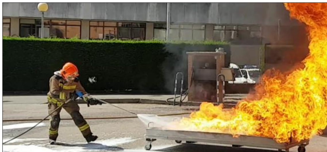
FireStop 200, extinción de incendio de hidrocarburos con tecnología 'Water Mist'.
